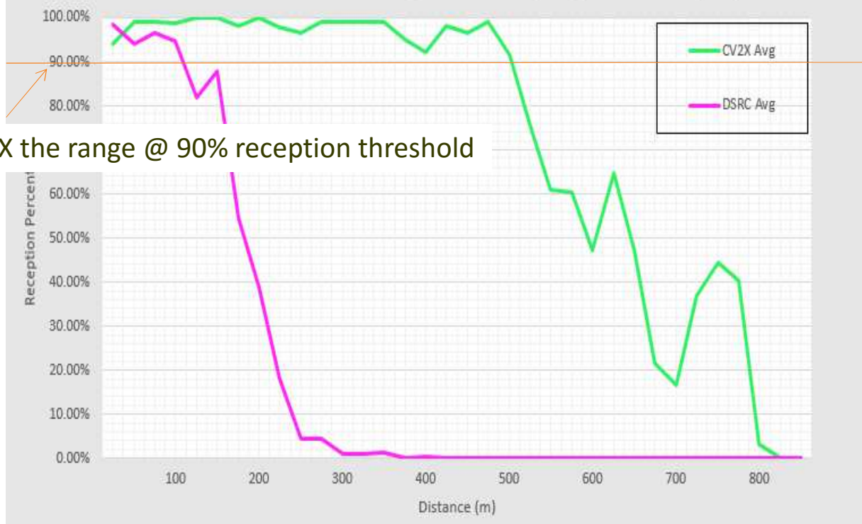
21dB NLOS Receding - TX:Veh1(HV) - RX:Veh2(RV)
